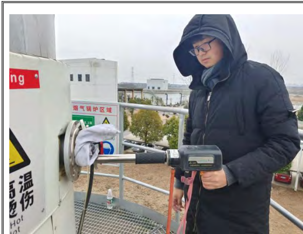
锅炉废气检测
